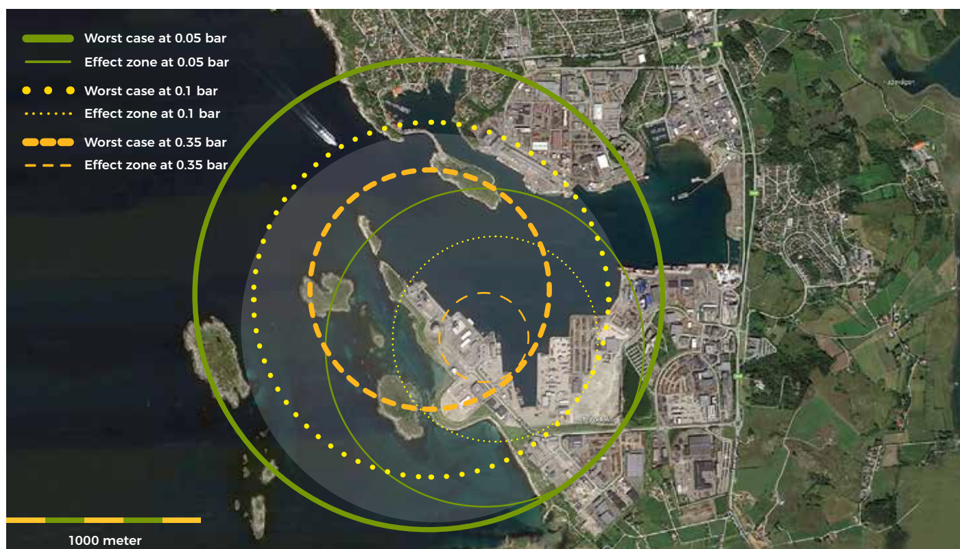
Ulike effektsoner ved en gasseksplosjon. Det innerste settet illustrerer fareavstander ved et gitt lekkasje- eller antennespunkt ved den hyppigst forekommende vindretningen under værforhold som gir størst fareavstand. Det ytterste settet med effektsoner illustrerer summen av fareavstandene ved alle mulige lekkasje- eller antennespunkt, ved alle vindretninger, under værforhold som gir størst fareavstand. Den grå ringen indikerer en 1000 meter radius.
